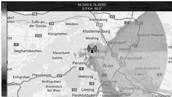
Abbildung 7: Dieses Diagramm stammt aus einem Programm zur Antennensimulation unter Einbeziehung der topografischen Gegebenheiten. Der Standort ist die „NSA-Villa“ in Wien, Pötzleinsdorfer Straße 126, der grüne Bereich zeigt an, welche Bereiche Wiens von den Antennen dort abgedeckt werden können – Radio Flux
